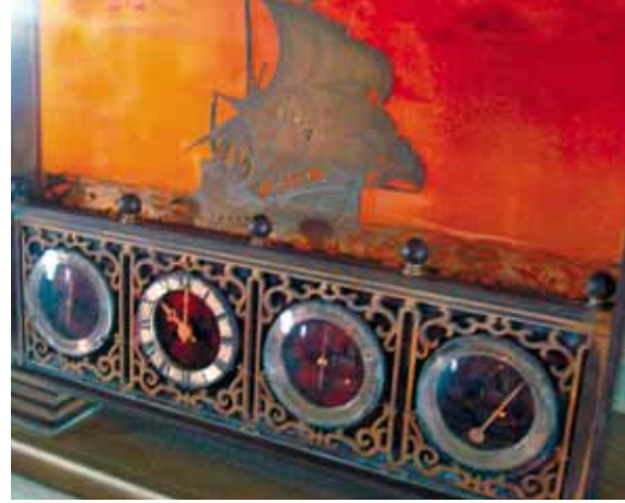
لوحة القياس التي تبين الوقت وحالة البحر ودرجة الحرارة والضغط الجوي
